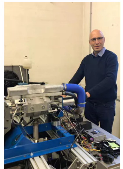
開発したエンジンはピストンが左右に強力に動く独自の機構を持つ
